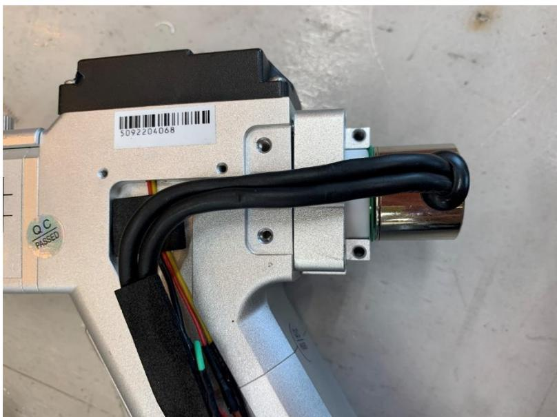
黒いコードが接続されているモーターを引き抜きます。
