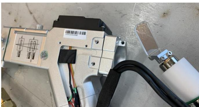
モーターを引き抜いたら、レーザーガン内部に異物が入らないように、開口部にテープを貼り、目張りします。
