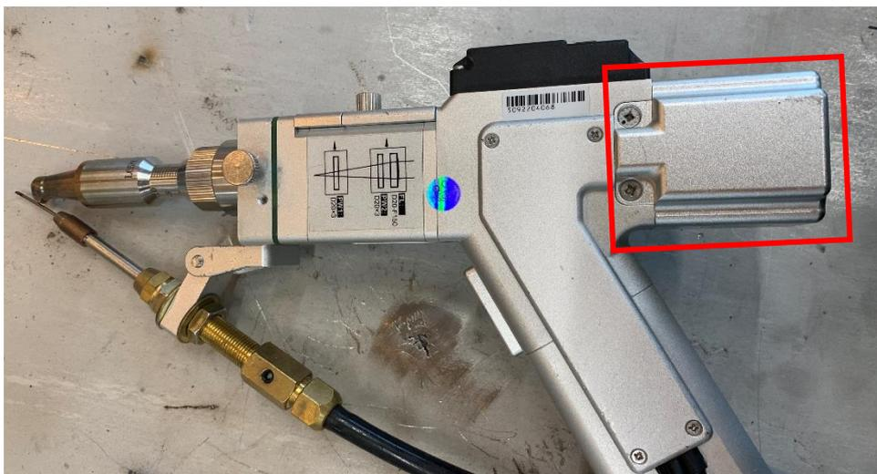
プラスドライバーを使用し、固定されている4ヶ所(片面2個)のネジを取り外します。
