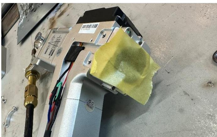
反射レンズを取り外すには六角ネジ2ヶ所を緩め、レンズケースを引き抜きます。
