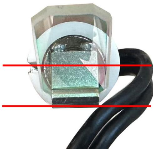
加工機の電源を入れて下さい。レッドポインターがレーザーノズルの先端から照射されるまでモーターを手で回しながら調節して下さい。レッドポインターが表示される位置で電源を入れた際にネジの締め付けが甘いと、キーキー音と共にモーターが過熱します。
