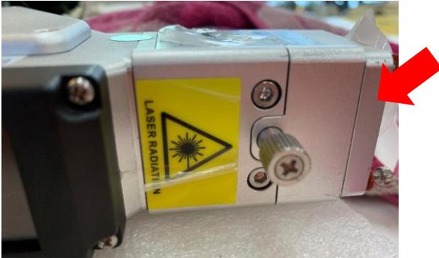
つまみを反時計方向に回します。保護レンズの取り付けプレートを引き抜きます。
