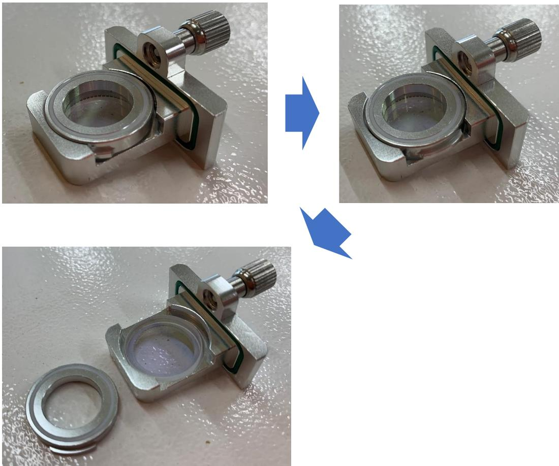
保護レンズを水道水で洗い流すか、アルコールやレンズクリーナーを十分に塗布し、表面に付着した塵などを洗い流した後、クロスやティッシュペーパーで軽く拭ってください。清掃後、照明などに透かしてみて、透明であることを確認してください。
