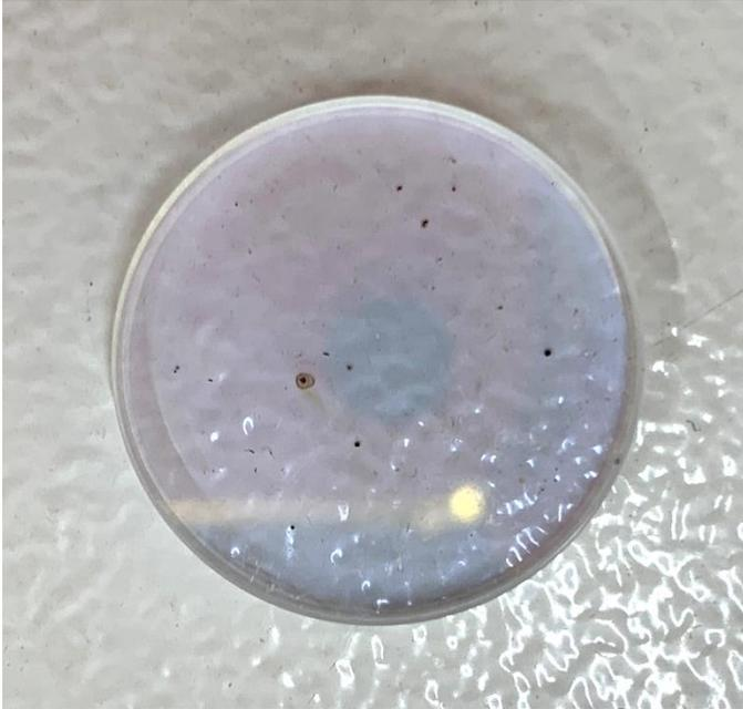
左の図の様に焦げや汚れが固着して取れない場合や、曇りや汚れがとれない場合、傷などの損傷がある場合は、保護レンズの交換が必要です。
