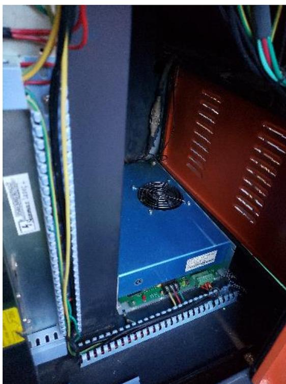
④ レーザー電源に接続されている端子とネクタを外します。
