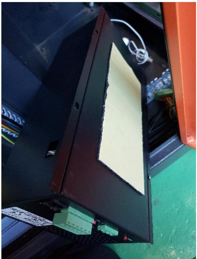
⑨ 150W Fタイプを置き、FG線をネジ穴に固定します。固定用に皿小ねじとナットを用意してください。
